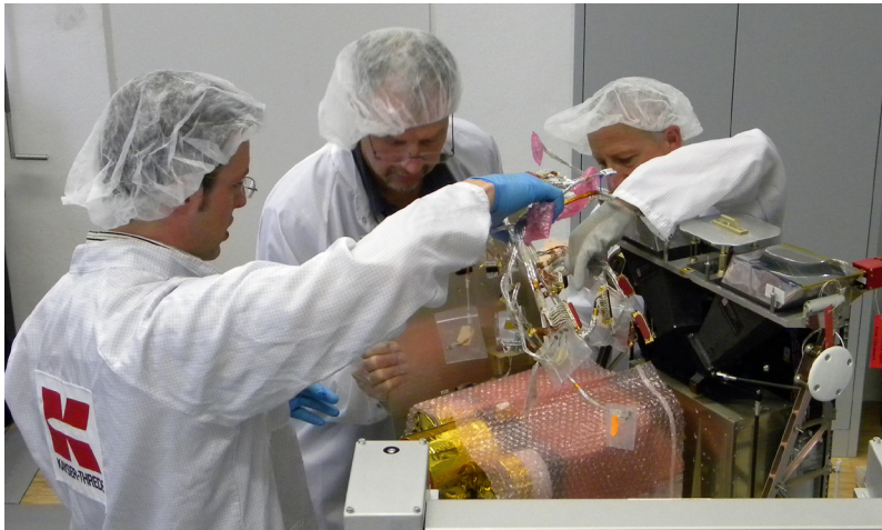
Integration des Satelliten TET (Plattform mit Nutzlasten) im Reinraum bei Kayser-Threde
